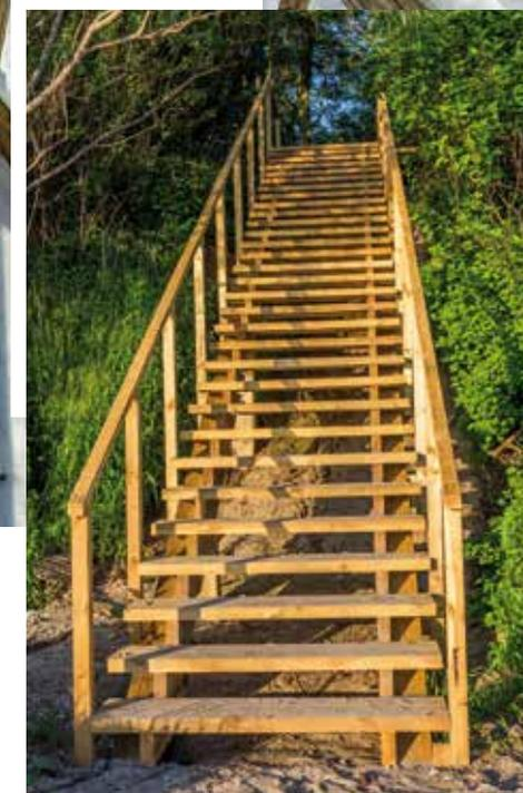
Les escaliers extérieurs sont composés de limons pré-entailés permettant de recevoir des marches. Ces limons sont en pin traités CL4, lamellés-collés et recoupables. Existent en 3, 5, 7 et 15 marches. S'adaptent sur tout type de support et permettent de réaliser des escaliers à la hauteur souhaitée.
